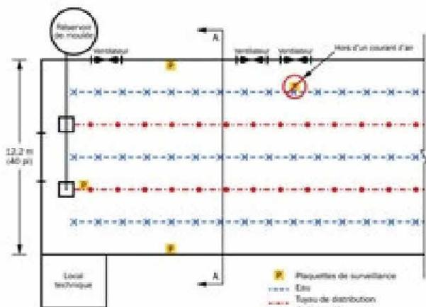
Figure 3. Vue en plan d'un bâtiment d'élevage montrant l'emplacement des plaquettes servant à la surveillance.
