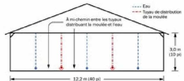
Figure 7. Vue en coupe d'un bâtiment d'élevage montrant les points de prélèvement des échantillons de fumier.
