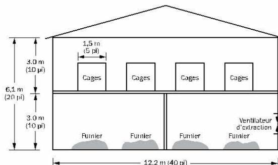
**Figure 46. Vue en coupe d'un bâtiment d'élevage de pondeuses en cages superposées.**
