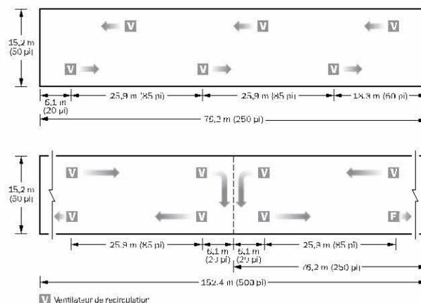
**Figure 12. Exemples de disposition des ventilateurs de recirculation à l'intérieur d'un bâtiment d'élevage de volailles.**
