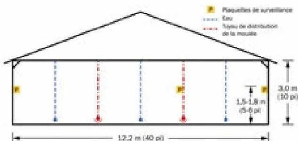
Figure 4. Vue en coupe d'un bâtiment d'élevage montrant l'emplacement des plaquettes servant à la surveillance.
