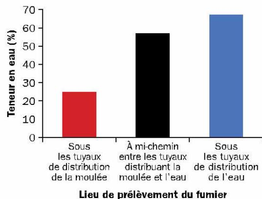
Figure 6. Exemple de teneurs en eau du fumier dans des échantillons prélevés, sur la largeur du bâtiment, sous les tuyaux de distribution de la moulée et de distribution de l'eau et à mi-chemin entre ces tuyaux.
